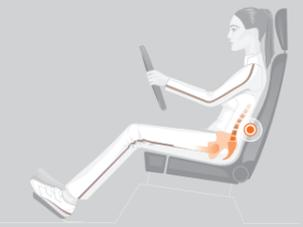
7. Die Seitenführungen des Sitzes sollten so nah am Körper liegen, dass der Oberkörper ohne Beugung angenehm seitlich unterstützt wird.
