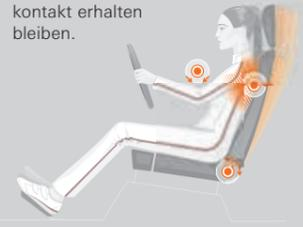
3. Die Sitzhöhe so hoch wie möglich fixieren. Dadurch wird ein nach allen Seiten und auf alle Anzeige-Instrumente freies Sichtfeld gewährleistet.
