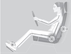
**2.** Die Schultern so dicht wie möglich an die Sitzlehne rücken. Die Rückenlehnenneigung so ausrichten, dass das Lenkrad mit leicht angewinkelten Armen gut erreicht wird. Beim Drehen des Lenkrads muss der Schulterkontakt erhalten bleiben.
