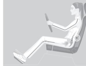
**7.** Die Seitenführungen des Sitzes sollten so nah am Körper liegen, dass der Oberkörper ohne Beengung angenehm seitlich unterstützt wird.
